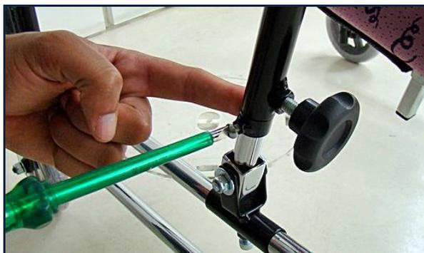
3.3.2. Ajustar a altura do cavalo (que deve ser compatível com a medida da altura usuário-cavalo), soltando os dois parafusos correspondentes.
