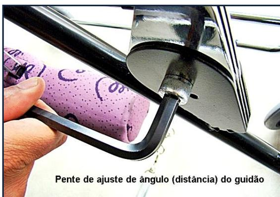
3.3.11. Ajustar as manoplas abrindo o parafuso indicado e após realizar o ajuste, apertar firmemente.
