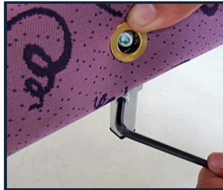
3.3.3. Ajustar o centro de massa do Transfer soltando o parafuso indicado. Logo após, apertar firmemente. **Este centro de massa é determinado para manter o equilíbrio das forças atuantes no equipamento.**
