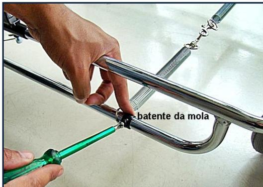
As molas devem ser alinhadas, quando necessárias, com os pés. Reapertar o batente, pois é ele que impede o deslizamento da mola na base.
