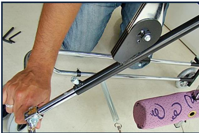
3.3.5. Este parafuso permite uma segunda opção para ajustar a altura da modulação. Ao liberar o mesmo pode-se ajustar o comprimento da haste do cavalo, mais para cima ou mais para baixo. Também permite dar mais espaço para descer o estabilizador de quadril, ou subir o estabilizador de tronco.
